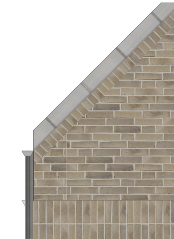
Takfotsdetalj med tegel i rullskift och utan takutsprång.
