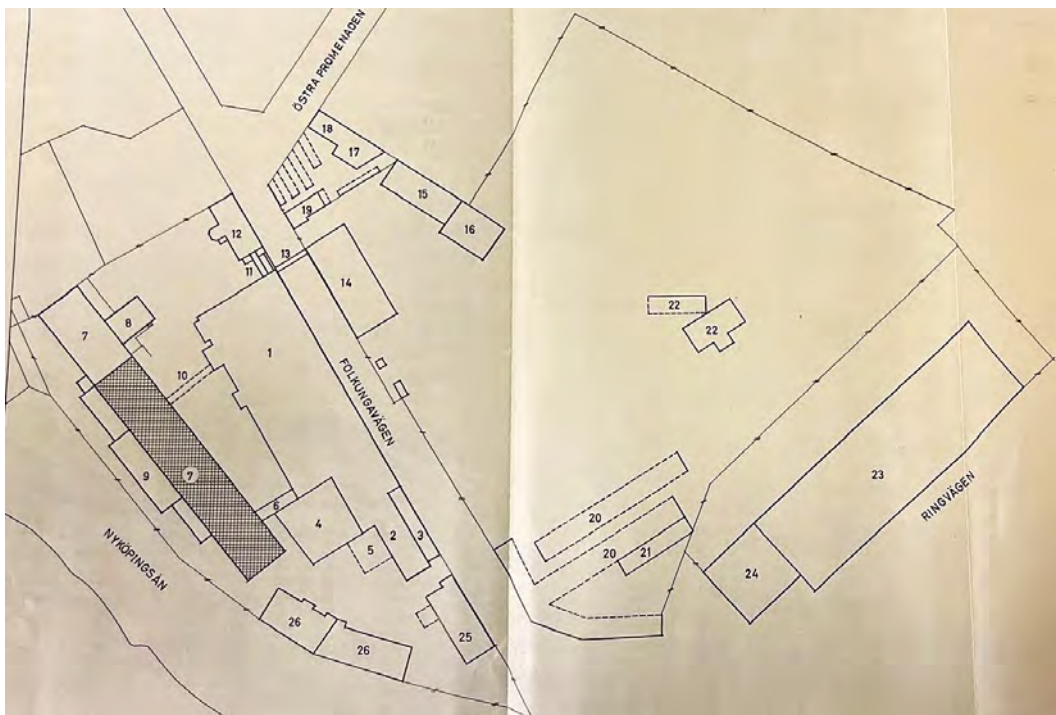
Figur 19. Situationsplan över NK:s verkstäder 1958. Kv. Brädgården innehåller bl.a. ett sågverk (14) ett spånhus (15) ett förråd (16) två garage (17-18), en lokal för brandkår (19), trälager (20), ytterligare förråd (21 -22) och bilhall (23) med verkstad (24). Källa: Stadsarkivet, Nyköping.
