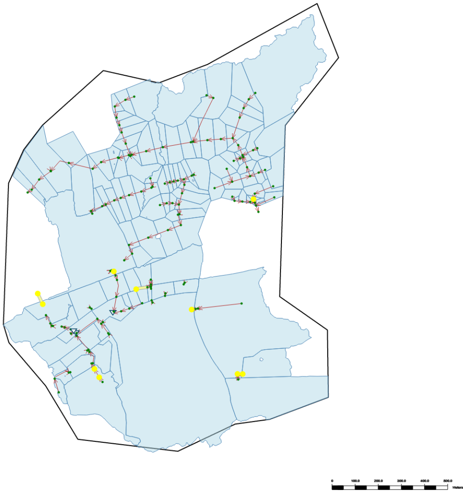
Figur 6. Ledningar och brunnar med okända och antagna vattengångar, markerade med gult.
