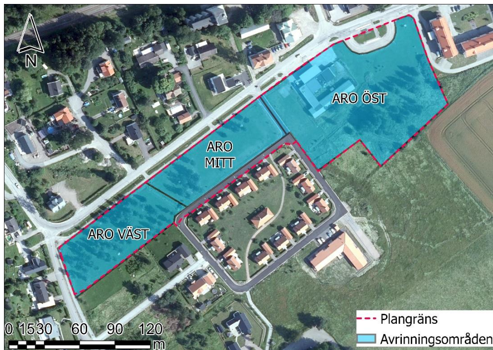
Figur 23. Avrinningsområdesfördelning för planerad situation. © Lantmäteriet.
