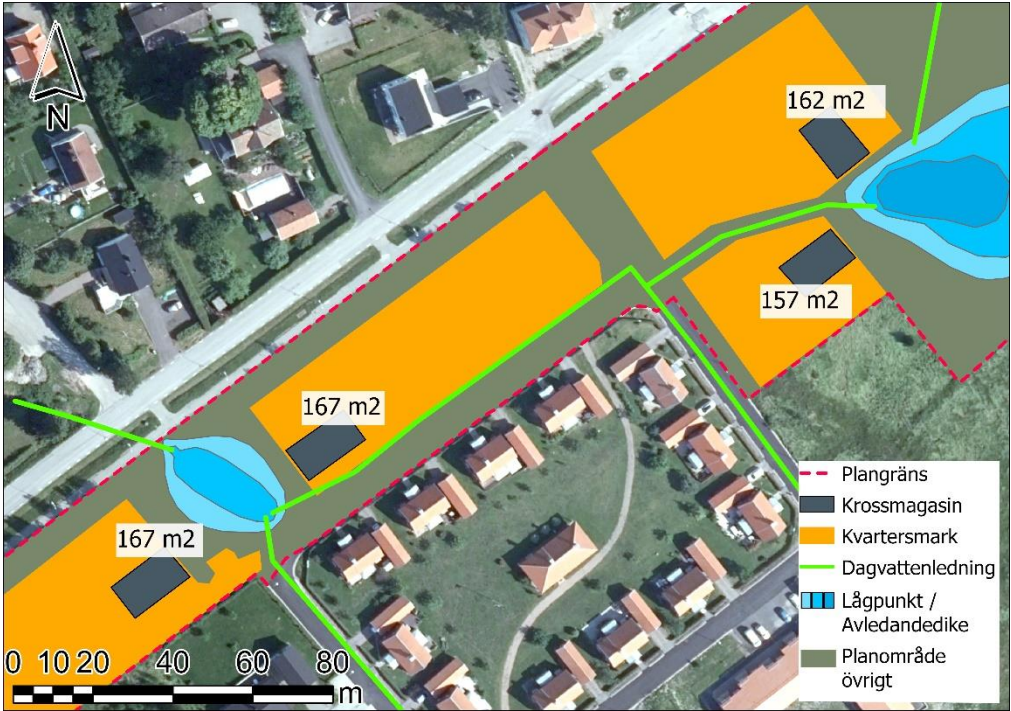
Figur 36. Skiss av krossmagasinens placering och ytbehov. © Lantmäteriet.
