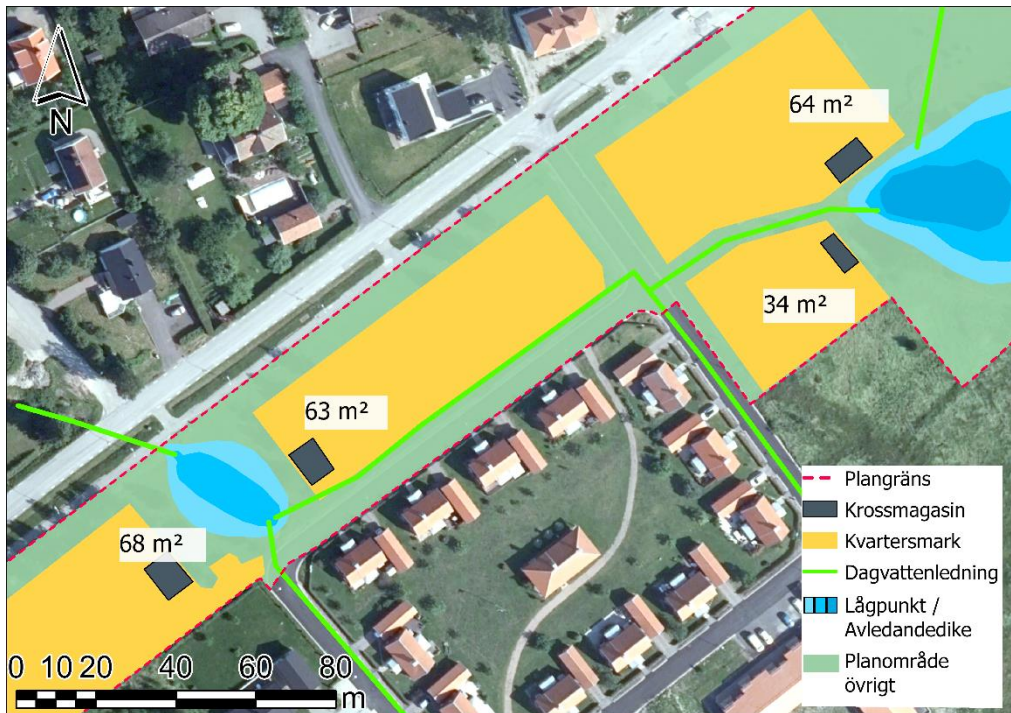
Figur 28. Skiss av krossmagasinens placering och ytbehov. © Lantmäteriet.
