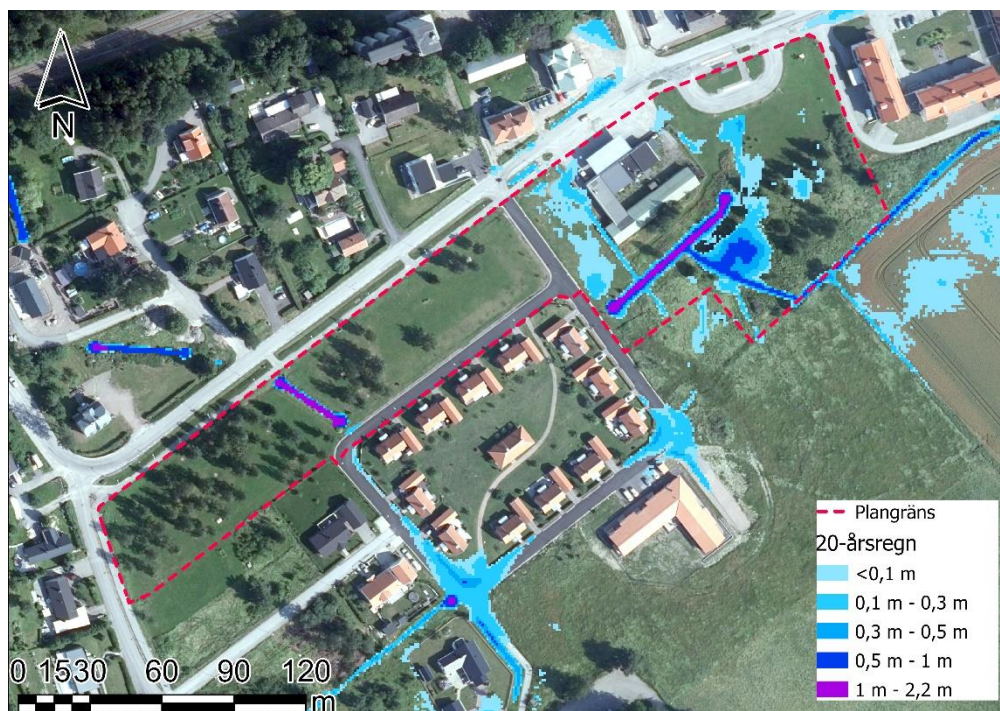
Figur 15. Simuleringsresultat för befintligt 20-årsregn vid planområdet. © Lantmäteriet.
