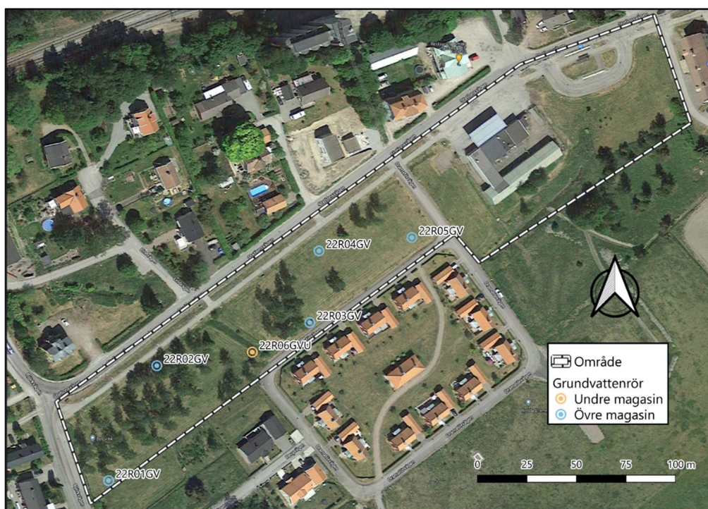
Figur 7. Placering av nyinstallerade grundvattenrör. Rör 22R01GV-22R05GV (blå) är installerade i det övre magasinet. Rör 22R06GVU (gul) är installerad i det undre magasinet. I 22R06GVU utfördes även en sondering. Bakgrundskarta från Google (Google, u.d.).
